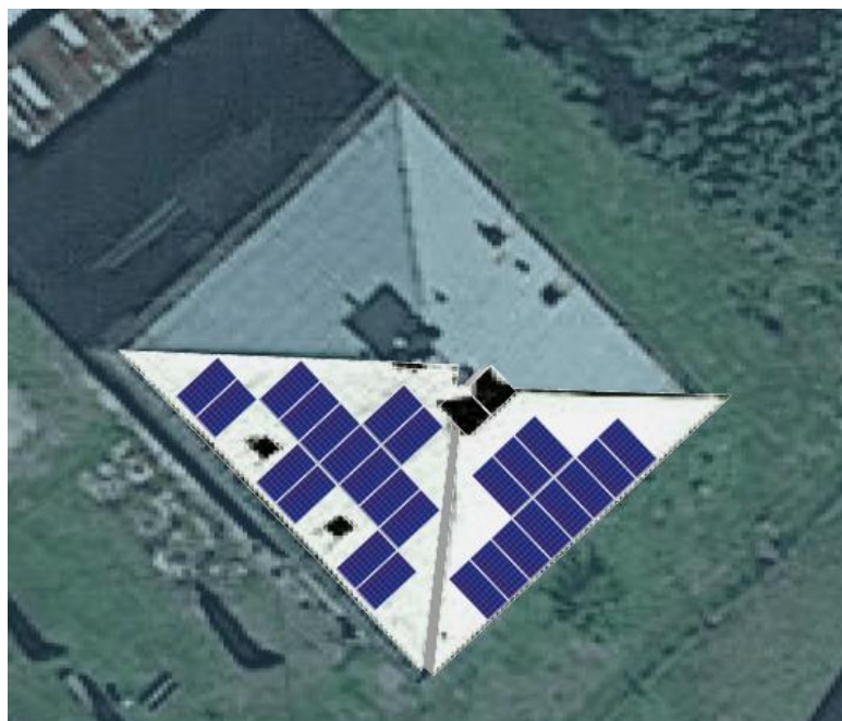
Obrázek 5 Rámcové instalační schéma panelů na objekt zdravotního střediska
